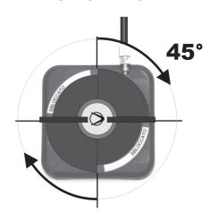
Ricordarsi di riportare la manopola dello SBLOCCO MANUALE in posizione 1 BLOCCATO per ripristinare il funzionamento dell'elettroblocco in condizioni di lavoro con alimentazione di rete.
