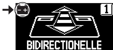
Absence d'alimentation de réseau et fonctionnement de la porte avec batterie chargée.
