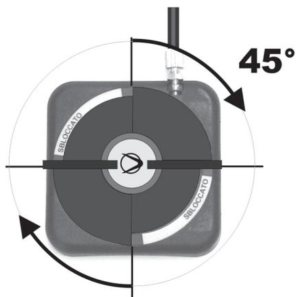
Se rappeler de replacer la poignée de DÉBLOCAGE MANUEL en position 1 BLOQUÉ pour rétablir le fonctionnement de l'électroblockage en condition de travail avec alimentation électrique.
