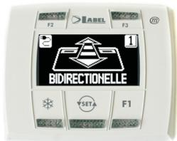
Avec une pression sur le bouton **VSETA** choisir le mode opérationnel de la porte automatique. A chaque fois qu'on appuie sur le bouton, on passe d'un programme de travail à l'autre.
