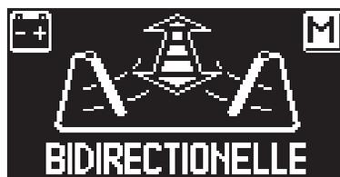
Absence d'alimentation de réseau et fonctionnement de la porte avec batterie chargée.
