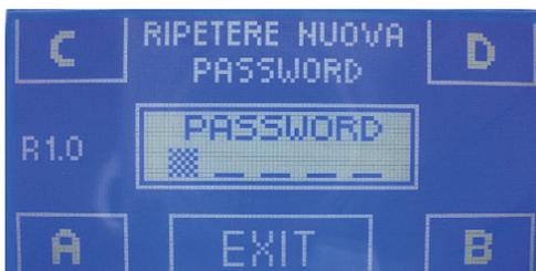
Dopo aver composto la password per la prima volta, viene richiesta la ripetizione della combinazione per una seconda volta. Digitare di nuovo la password precedente.
