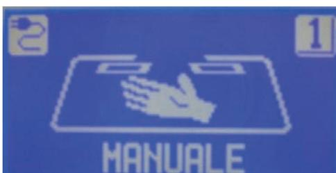
Il funzionamento automatico della porta è disattivato ed è possibile spostare le ante manualmente.
