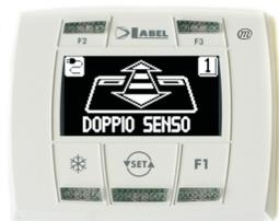
Premendo con un impulso il pulsante
