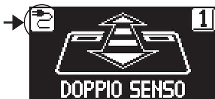
Presenza di alimentazione di rete e batteria collegata in stato di carica.
