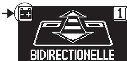
Absence d'alimentation de réseau et fonctionnement de la porte avec batterie chargée.
