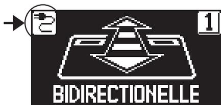
Présence d'alimentation de réseau et batterie connectée en état de charge.
