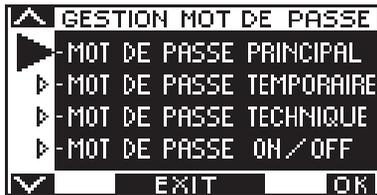
Dans cette section il y a deux mots de passe qui peuvent être utilisés par l'utilisateur final, le mot de passe primaire et le mot de passe de service.
